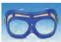
9. B-B 19 uzavřené ochr. brýle s přímou ventilací, osazené čirými zorníky z PC, k ochraně očí před nárazem pomalu letících částic nebo hrubým prachem
